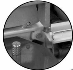
2. Schieben Sie Grundplatte von unten in die Haken am Heck des Kranes ein und fixieren Sie diese mit den beiliegenden Bolzen rechts und links am Oberwagen des Kranes.
